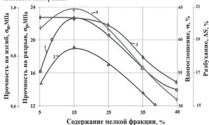
Рис. 2. Зависимость влияния содержания мелкой фракции на физико-механические свойства композиционных плит. 1 — прочность на изгиб, \sigma_n ; 2 — прочность на разрыв, \sigma_r ; 3 — разбухание, \Delta S ; 4 — водопоглощение, W .
