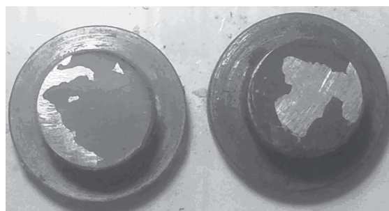
Рис. 4. Стальные цилиндры («грибки») с адгезионным слоем композита после испытания на отрыв.
