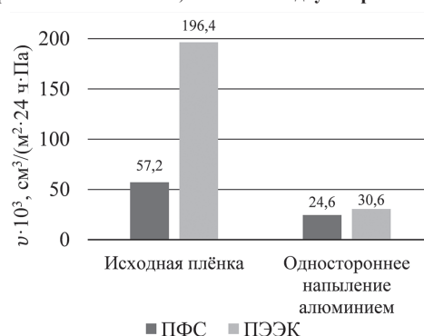
Рис. 8. Влияние одностороннего напыления алюминия на скорость газопроницаемости ПФС- и ПЭЭК-плёнок.
