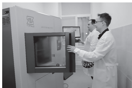
Рис. 3. Проектирование изделий для 3D-печати и 3D-принтер для высокотемпературной печати термостойких полимеров (ПСФ, ПЭЭК, ПЭКК и др.) и композитов.
