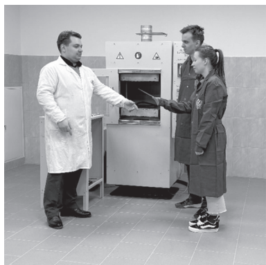
Рис. 5. Технологическая лаборатория и высокотемпературный пресс для получения высокопрочных армированных полимерных композиционных материалов слоистой структуры специального назначения.
