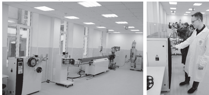
Рис. 1. Экструзионная линия для получения филамента из высокотемпературных термопластов (ПСФ, ПЭЭК ПЭКК и др.) и композитов в новой технологической мега-лаборатории кафедры ХТПП и ПК.
