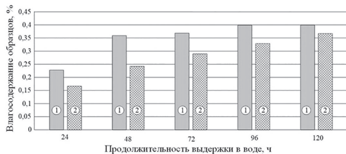
Рис. 4. Влагопоглощение образцов отвержденной полиэфирной смолы в зависимости от времени выдержки в воде: 1 – без облучения; 2 – после облучения НЭМИ (режим A = 15 кВ, f = 1000 Гц, \tau = 10 мин).
