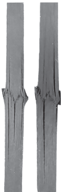
Рис. 5. Фотография разрушенного образца углепластика с объемным содержанием пор \sim 0,1\% .
