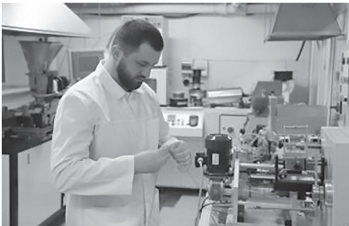
Рис. 5. Установка по производству филамента из полимерных материалов.
