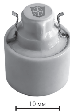
Рис. 5. Внешний вид поверхности корпуса источника тока, изготовленного из пресс-материала АГ-4В (трещина с протекавшим электролитом, образовавшаяся на месте дефекта типа стыка потоков материала).
