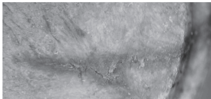
Рис. 5. Внешний вид поверхности корпуса источника тока, изготовленного из пресс-материала АГ-4В (трещина с протекавшим электролитом, образовавшаяся на месте дефекта типа стыка потоков материала).
