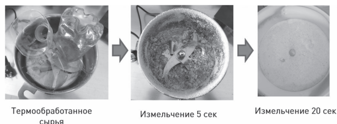
Рис. 2. Характер измельчения материала.
