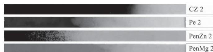
Рис. 5. Внешний вид образцов CZ 2, Pe 2, PenZn 2 и PenMg 2 после проведения оценки остаточной эффективности термостабилизатора.
