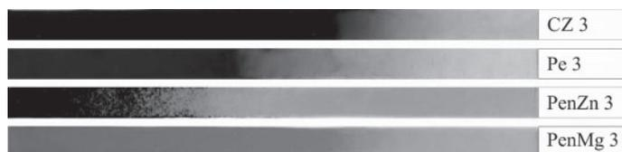
Рис. 6. Внешний вид образцов CZ 3, Pe 3, PenZn 3 и PenMg 3 после проведения оценки остаточной эффективности термостабилизатора.
