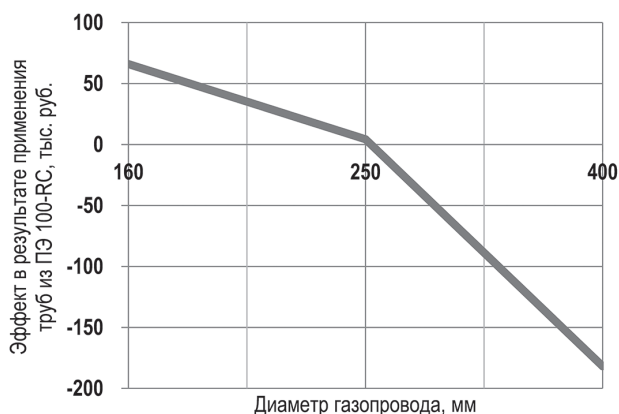
Рис. 1. Зависимость эффекта в результате применения полиэтиленовых труб с соэкструзионными слоями из ПЭ100-RC на внешней и/или внутренней поверхности трубы по сравнению с трубами ПЭ100 от диаметра газопровода при прокладке траншейным методом в тыс.руб.
