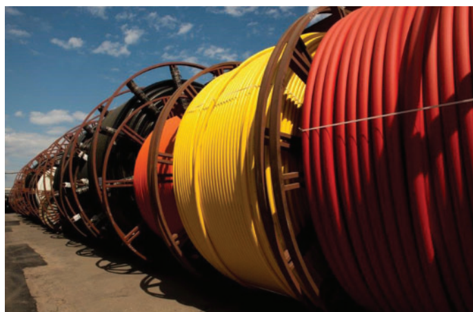
Рис. 5. Барабаны с армированной тепловой трубой больших объёмов непрерывной длины.
