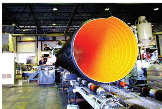
Рис. 3. Технологическая линия по производству трубы КОРСИС Арм.
