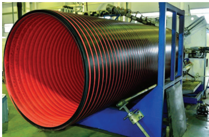
Рис. 4. Технологическая линия по производству трубы СПИРОЛАЙН.
