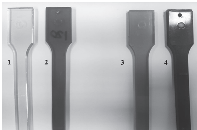
Рис. 1. Изменение цвета образцов ПСФ-190 и Udel P1700 после термоокислительного старения: 1 – Udel P1700 исходный; 2 – Udel P1700 после термоокислительного старения при 170°C в течение 6000 ч; 3 – ПСФ-190 исходный; 4 – ПСФ-190 после термоокислительного старения при 170°C в течение 6000 ч.
