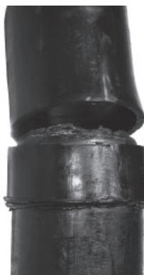
Рис. 4. Характер разрушения раструбного соединения под действием внутреннего давления.
