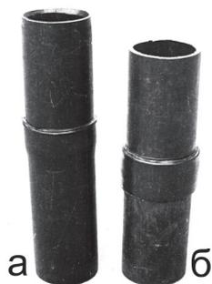
Рис. 1. Сварные соединения, используемые на первых полиэтиленовых газопроводах: с отформованным раструбом (а) и с литевой подвижной муфтой (б) (фото из архива АО «Гипроннигаз»).
