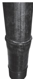
Рис. 2. Образец раструбного сварного соединения, вырезанного из газопровода к пос. «Совхозный» и подготовленного к проведению гидравлических испытаний.
