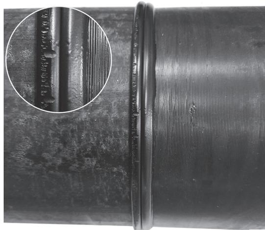
Рис. 7. Валики грата сварного шва, полученного путем сварки труб из ПЭ 100 (слева) и ПЭ 63 (справа).
