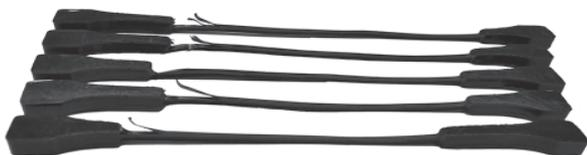
Рис. 3. Характер разрушения образцов-лопаток после проведения механических испытаний на осевое растяжение.
