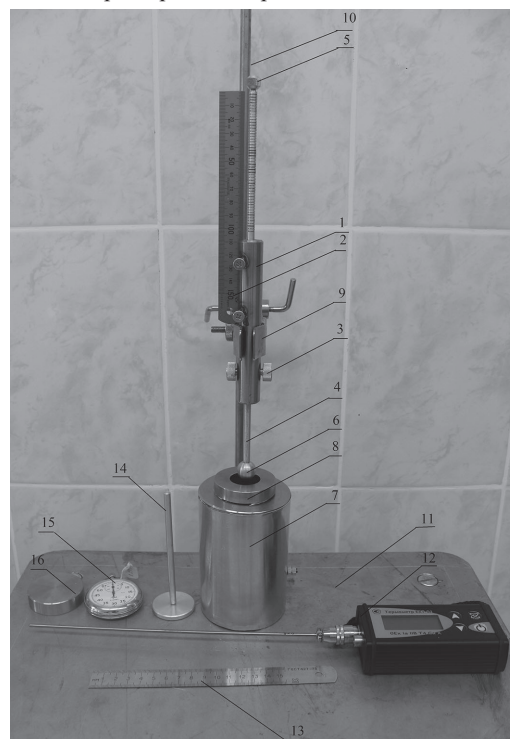
Рис. 1. Общий вид штативного пенетromетра и вспомогательные устройства для проведения измерений: 1 – корпус, 2, 13 – измерительная линейка по ГОСТ 427, 3 – винты, 4 – стержень, 5 – упор, 6 – индентор – сфера, 7 – цилиндрическая чаша, 8 – крышка с отверстием, 9 – лапка, 10 – штатив, 11 – подставка, 12 – термометр электронный, 14 – придавливающее устройство, 15 – секундомер механический, 16 – крышка.
