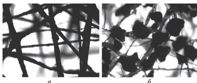
Рис. 1. Микрофотографии наполненных волокнистых материалов (увеличение  $\times 40$ ), полученных аэродинамическим способом формирования из раствора полиуретана (ПУ) в диметилформамиде (ДМФ): а – наполнитель (мелкодисперсный активированный уголь 208СР) находится внутри волокон; б – наполнитель (гранулированный активированный уголь «Каусорб») находится в межволоконном пространстве.
