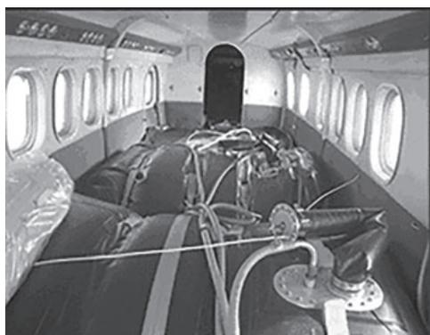
Рис. 1. Эластичные резервуары Turtle Pac в грузовой кабине самолета.
