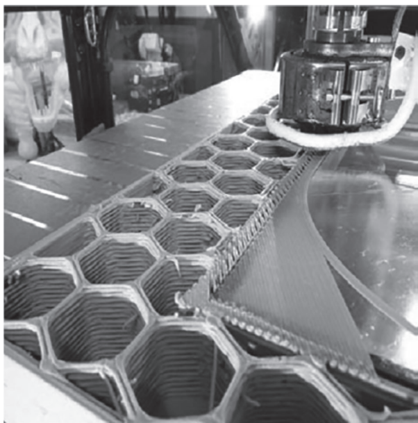
Рис. 3. АДТ крупногабаритного изделия из полимерных композитов на 3D-принтере TOTAL-Z.
