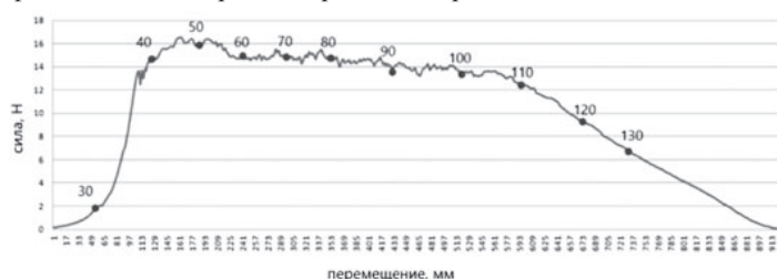
Рис. 19. Кривая раздира в условиях постоянно повышающихся температур. Цифры на кривой – температура (°C) в момент измерения усилия раздира.
