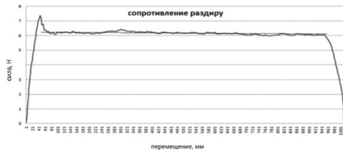
Рис. 18. Кривая раздира при постоянной температуре.
