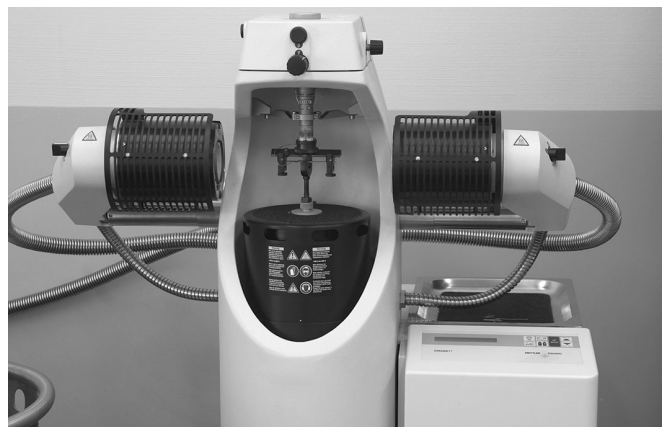
Рис. 3. Модуль DMA 861e с установленным зажимом для трехточечного изгиба с незакрепленными концами.
