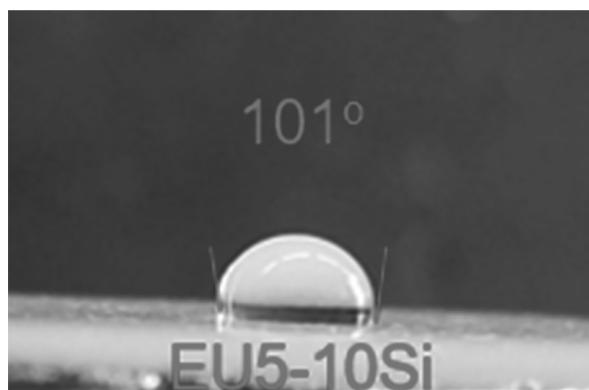
Рис. 8. Значения угла смачивания водой покрытий на основе ЭД-20: а) E, б) EU5, в) EU5-10Si.
