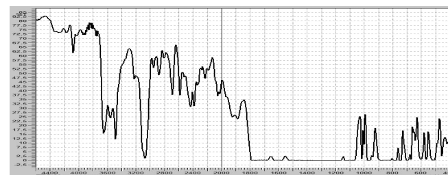
Рис. 8. ИК-спектр пленки. Выдержка при 240°C 30 минут.
