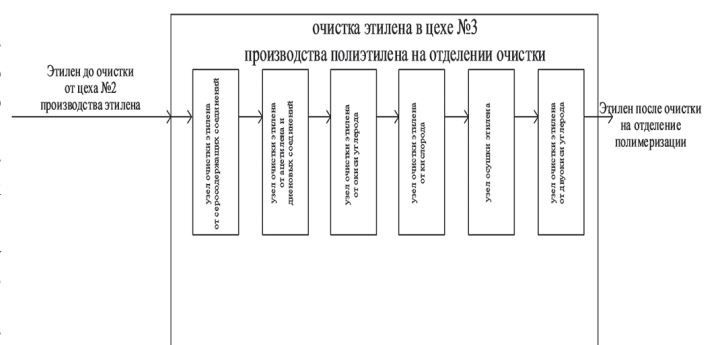
Рис. 2. Схема очистки этилена на производстве полиэтилена.
