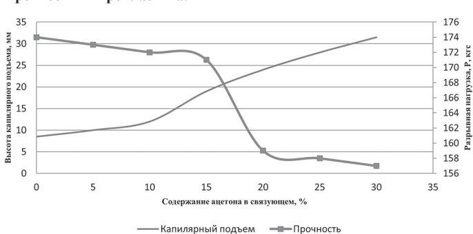
Рис. 16. Влияние содержания ацетона в связующем на основе форполимера СКУ-ПФЛ-100 на высоту капиллярного подъема на жгуте Руслан и прочность микропластика.
