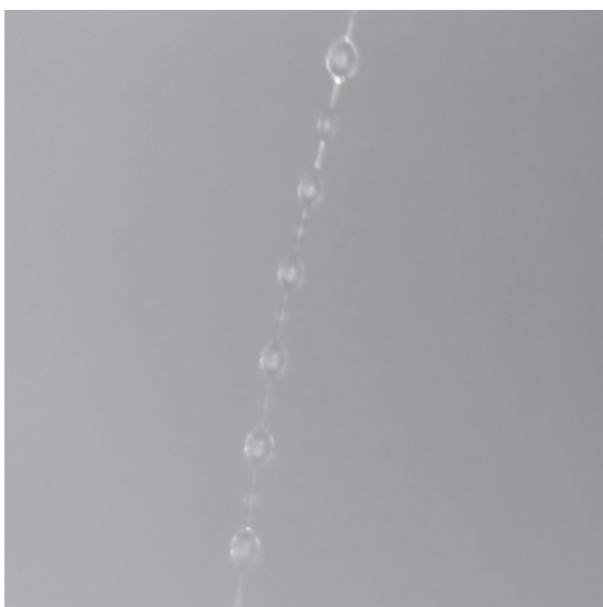
Рис. 13. Внешний вид образцов во время испытания. Связующее – СКУ-ПФЛ-100, моноволокно – Руслан.
