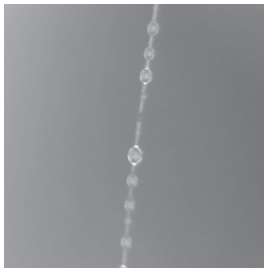
Рис. 11. Внешний вид образцов во время испытания. Связующее – СУРЭЛ ТФ-228, моноволокно – Руслан.
