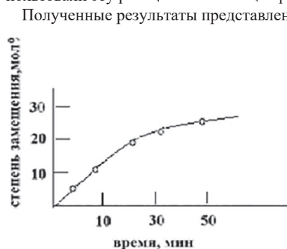
Рис. 2. Зависимость степени замещения от времени этерификации на границе раздела фаз. Органическая фаза бензол, хлорангидрид: ПВС=1 моль; 1 основно-моль, концентрация 0,5 М, температура 30°C, количество NaOH – 1 моль/моль хлорангидрида.
