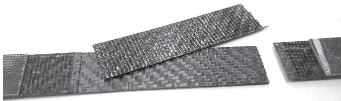
Рис. 8. Фотография разрушенного образца, изготовленного в соответствии с технологической схемой №1.
