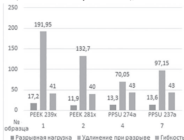
Рис. 1. Физико-механические свойства нитей диаметром ~400 мкм из различных полимеров.
