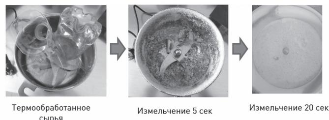
Рис. 2. Характер измельчения материала.
