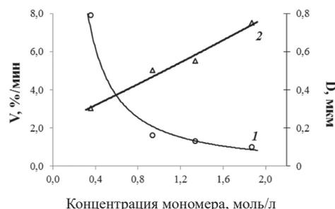
Рис. 10. Зависимость скорости полимеризации метилметакрилата (1) и средних размеров полиметилметакрилатных частиц (2) от концентрации мономера.
