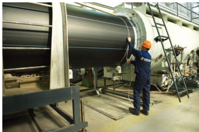
Рис. 1. Технологическая линия для производства трубы диаметром 1600 мм.
