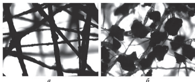
Рис. 1. Микрофотографии наполненных волокнистых материалов (увеличение \times 40 ), полученных аэродинамическим способом формования из раствора полиуретана (ПУ) в диметилформамиде (ДМФ): а – наполнитель (мелкодисперсный активированный уголь 208СР) находится внутри волокон; б – наполнитель (гранулированный активированный уголь «Каусорб») находится в межволоконном пространстве.
