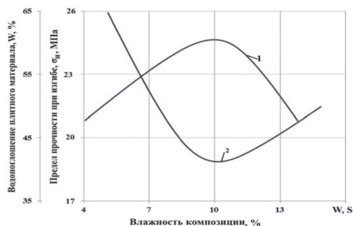
Рис. 5. Зависимость предела прочности при изгибе (1) и водопоглощения (2) плитного материала от влажности композиции. 1 – предел прочности при изгибе, \sigma_n ; 2 – водопоглощение плитного материала, W .
