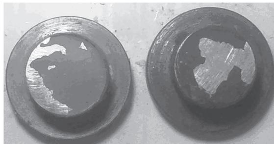
Рис. 4. Стальные цилиндры («грибки») с адгезионным слоем композита после испытания на отрыв.
