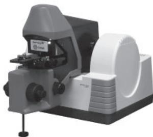
Рис. 4. ИК-Фурье спектрометр Nicolet iS5 с приставкой SurveyIR® в кюветном отделении.
