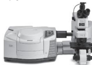
Рис. 5. ИК-микроскоп Nicolet iN5, присоединенный к ИК-Фурье спектрометру Nicolet iS20.
