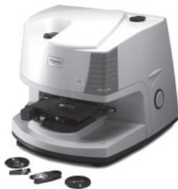
Рис. 7. Создающий спектральное изображение ИК-Фурье микроскоп Nicolet iN10 MX с приставкой ННВО.
