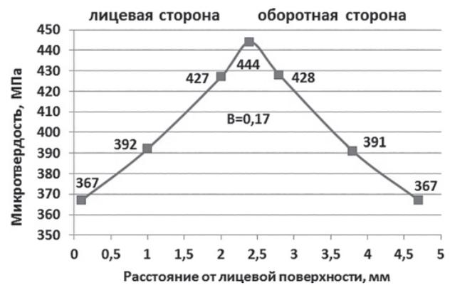
Рис. 4. Микротвердость полимерной матрицы стеклоуглепластика в различных сечениях трансверсального направления образца.
