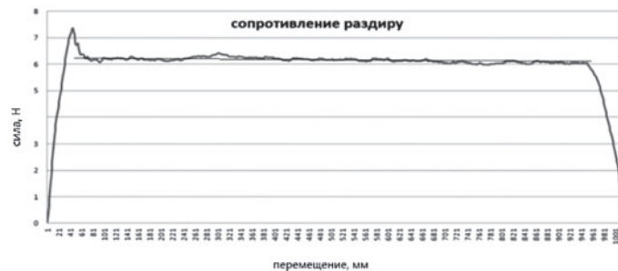
Рис. 18. Кривая раздира при постоянной температуре.
