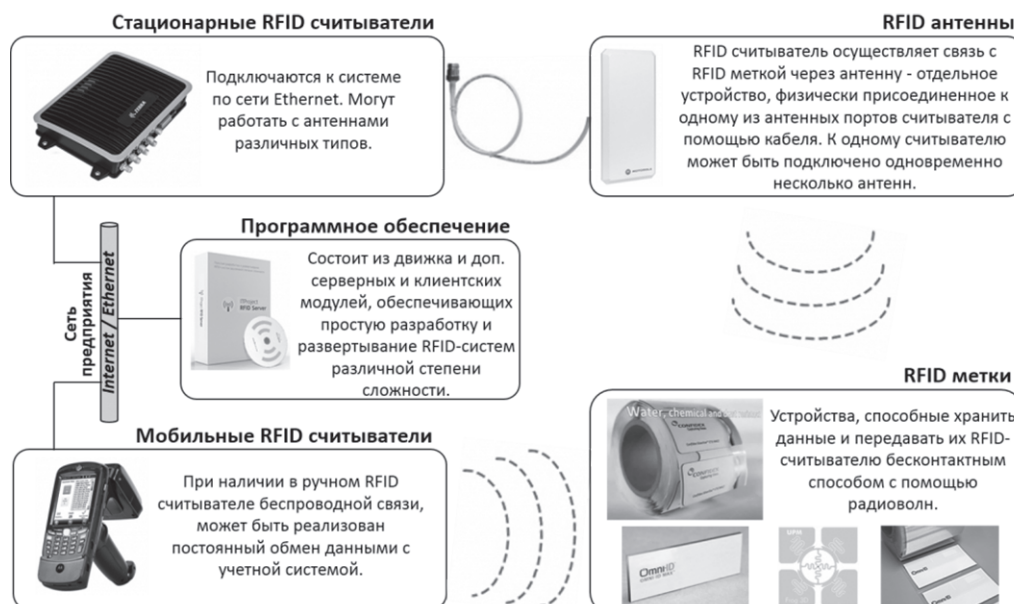
Рис. 4. Принцип действия устройства RFID.
