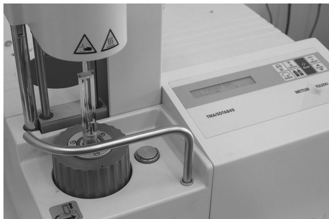
Рис. 1. Модуль TMA/SDTA 840e с установленным приспособлением для трехточечного изгиба с незакрепленными концами.
