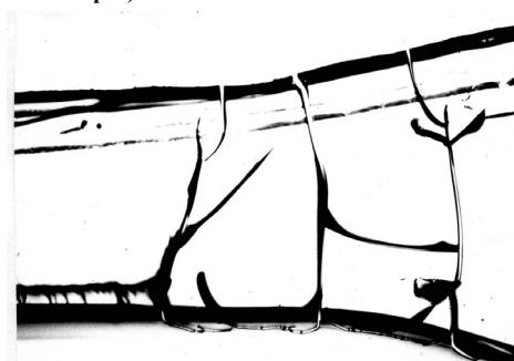
Рис. 9. Состояние отверженного фенолоформальдегидного связующего (увеличение 3000 раз).
