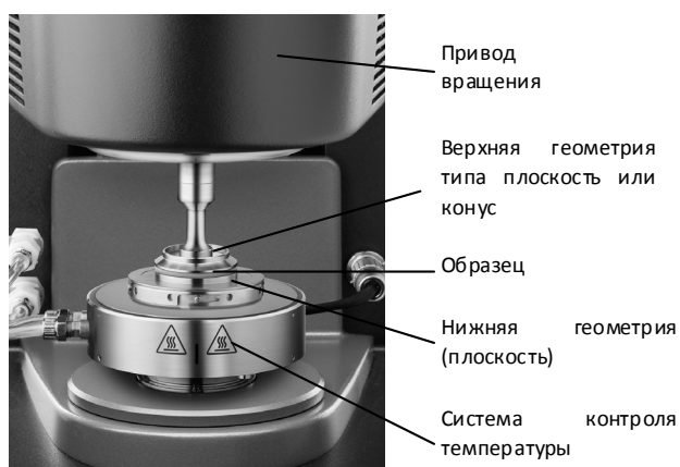
Рис. 2б: Расположение образца в ротационном реометре DHR производства TA Instruments. В ротационном реометре образец сдвигается между двумя пластинами или конусом и нижней пластиной. Вязкость рассчитывается как отношение приложенного механического напряжения и приложенной скорости деформации (скорость вращения). Ротационный реометр, в отличие от капиллярного реометра, также измеряет свойства материала, зависящие от времени.
