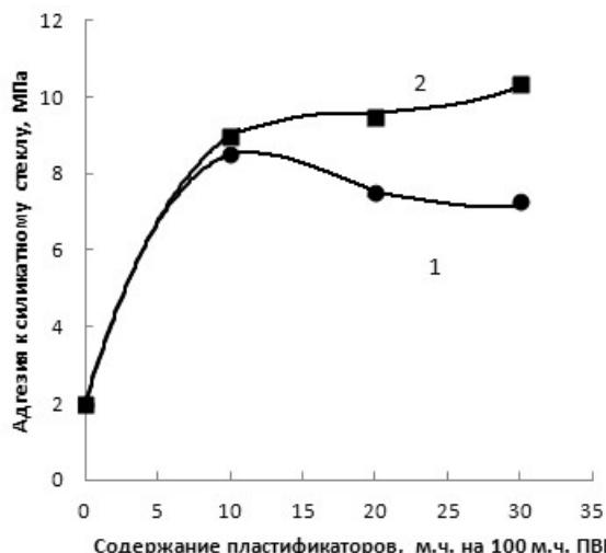
Рис. 3. Зависимость адгезионной прочности пленок от содержания пластификаторов ДОА (1) и ДБС (2).
