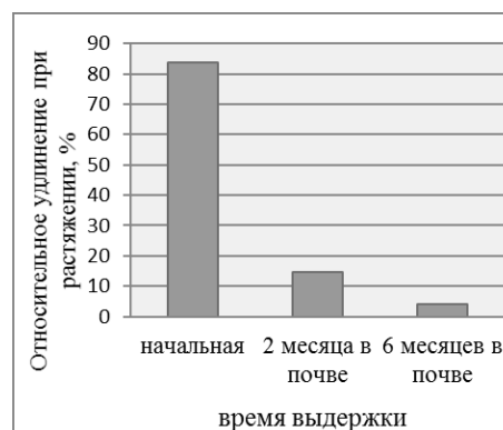
Рис. 11. Изменение относительного удлинения пленок при растяжении 70 мас.% ПМК : 30 мас.% ПЭВП + 5 мас.% ДСТ от времени выдержки в почве при 25°C.
