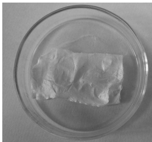
Рис. 2. Пленка 50 мас.% ПМК + 50 мас.% ПЭ после действия растворителя (хлороформ).
