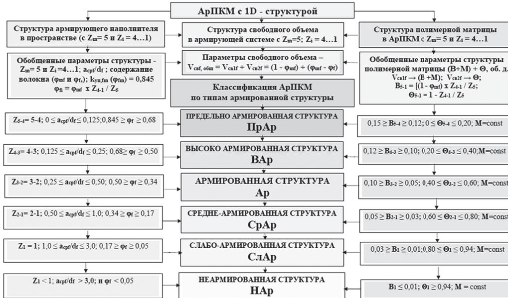
**Рис. 5.** Классификация армированных (1D-структура) полимерных композиционных материалов по структурному принципу.
