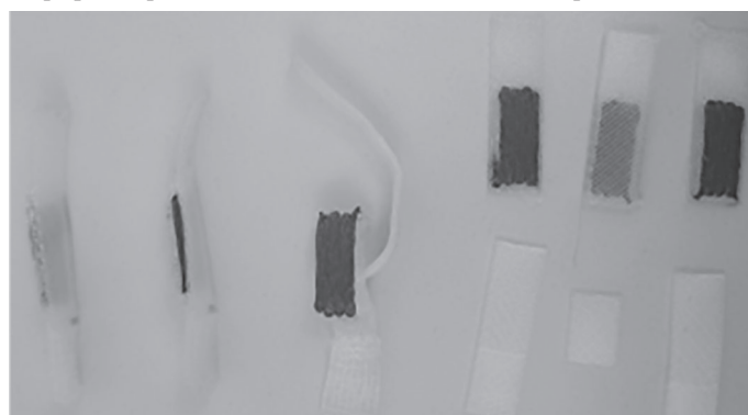
Рис. 4 Фотографии образцов АрПКМ на основе ТПУ, армированные непрерывным УВ с пропиткой ПА-6, испытанные на межслойную адгезию при воздействии сдвиговой нагрузки.
