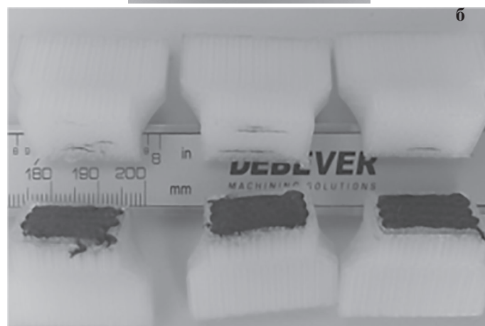
Рис. 2. Фотографии напечатанных образцов ТПУ, армированных непрерывным углеволокном с пропиткой ПА-6, после испытаний на прочность при растяжении (а) и межслойную адгезию методом отрыва (б).
