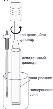
Рис. 1. Лабораторная установка для проведения сополимеризации НМПЭ с МА и ХЗ.
