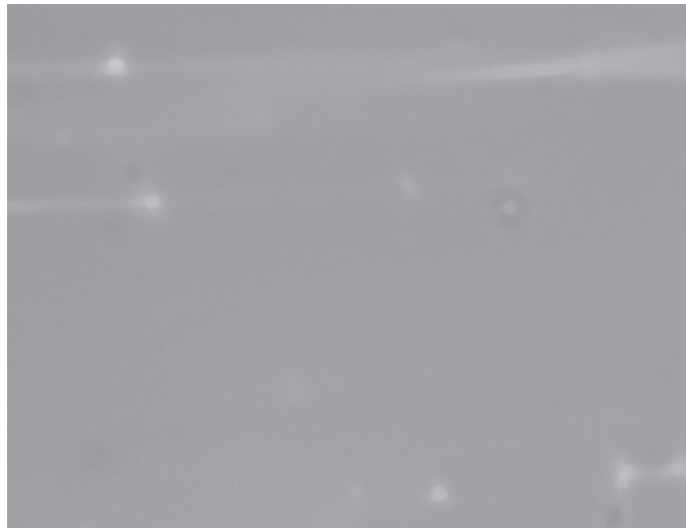
Рис. 5. Фото внешнего вида пятен на поверхности препрега КМКС (А).
